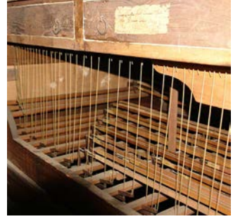
Wellaturrahmen Manual, Zettelsignatur am Windladenspund
