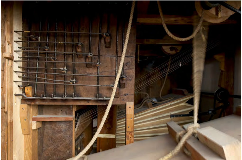
J. K. Wörle, Orgel ca. 1764, Corté, Église de l'Annonciation, Mehrfaltenkeilbalg mit nachträglich eingebauter mechanischer Aufziehvorrichtung.
