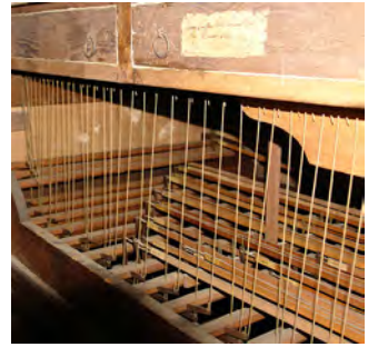
Wellaturrahmen Manual, Zettelsignatur am Windladenspund
